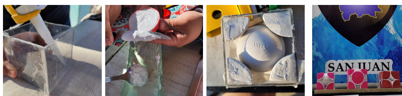
Figura 4: Construcción de celda cúbica centrada en el cuerpo con esferas de yeso.
