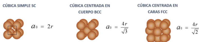
Figura 1: Esquema de las tres celdillas unidad cúbicas ( a_0 =arista del cubo).
